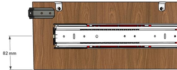
3. Fixe a base, as laterais e a divisória, utilizando parafusos de 4 mm x 45 mm. Sempre faça um pré-furo com broca de 3 mm e utilize escareador de 8 mm para embutir a cabeça do parafuso. Você pode usar tapa-furos adesivos ou plásticos para dar acabamento nesses pontos.
