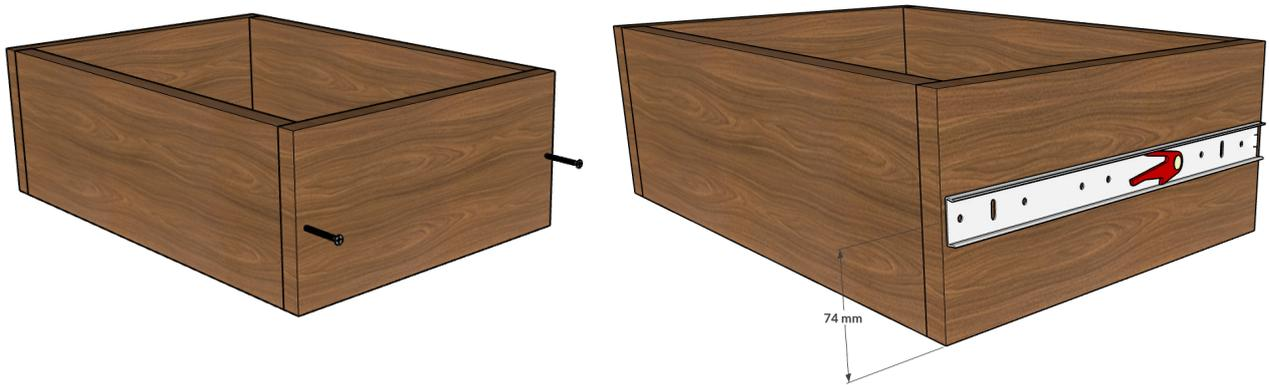
6. Encaixe as gavetas no corpo do móvel, verificando se elas deslizam corretamente. Em seguida, faça a fixação dos frentes de gaveta e dos puxadores, parafusando pela parte interna com parafusos de 4 mm x 30 mm.
