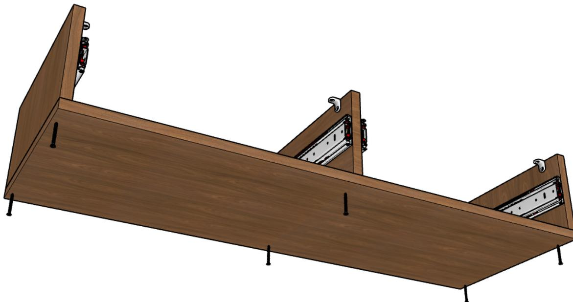
4. Fixe o tampo do móvel com parafusos de 4 mm x 16 mm, utilizando as cantoneiras tipo "cadeirinha". Não se esqueça de conferir o alinhamento de todas as peças, principalmente da divisória.
