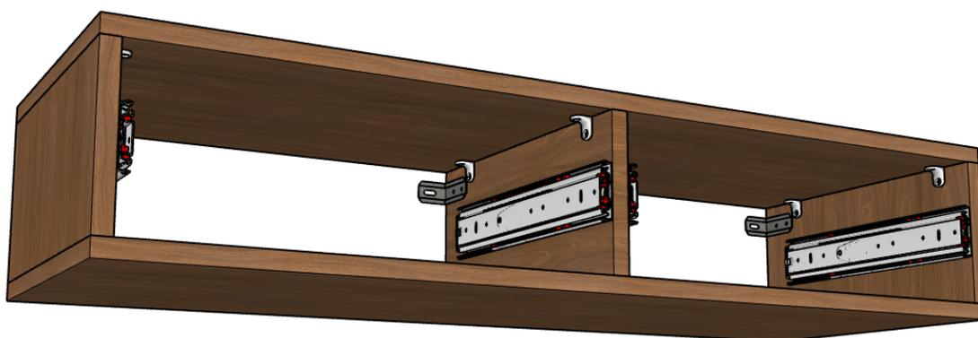
5. Monte as gavetas utilizando parafusos de 4 mm x 45 mm e, na sequência, instale os trilhos das corredeiras, também centralizando na altura.
