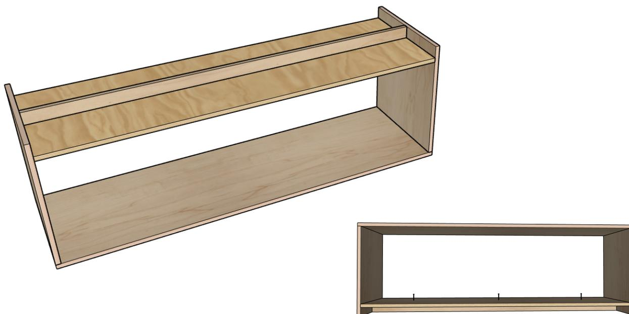
4. Faça a fixação das divisórias internas do rack seguindo as recomendações do início do manual de montagem. Lembre-se de fixar tudo utilizando cola PVA e parafusos de 4mm x 45mm.
