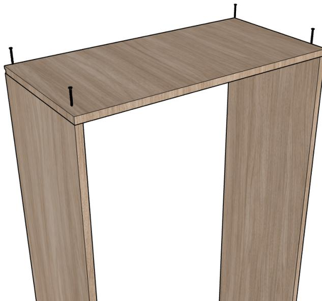
5. Realize a fixação do fundo do móvel com parafusos de 3,5mm x 20mm, pregos 10x10 ou um pinador com pinos de 20mm.
